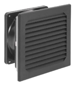
Filter fan 42/63(m³/h) IP54 230VAC 19W 42dB - Switchgear cabinet ventilator MES-FLL
